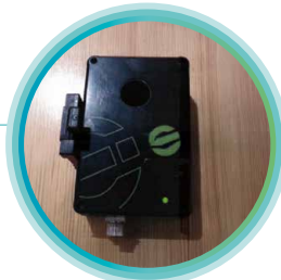
Rys. 2. Moduł bezstykowego pomiaru prądu (program CBT) certyfikacja badania typu
