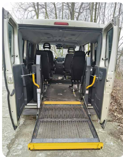
Rys. 18. Urządzenia dla osób niepełnosprawnych zainstalowane w pojeździe
