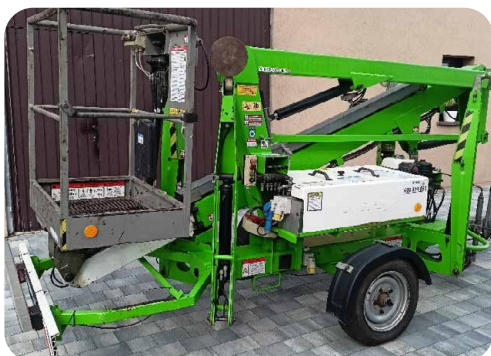
Rys. 15. Podesty ruchome przejezdne zamontowane na pojeździe i podwoziu przyczepy
