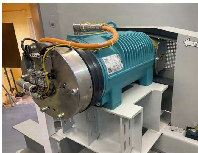
Zdjęcie maszyny z wciągarką bezreduktorową
