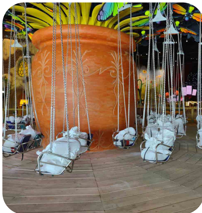
Rys. 4. Przeprowadzanie badania urządzenia z obciążeniem (zdj. M. Klahs)
