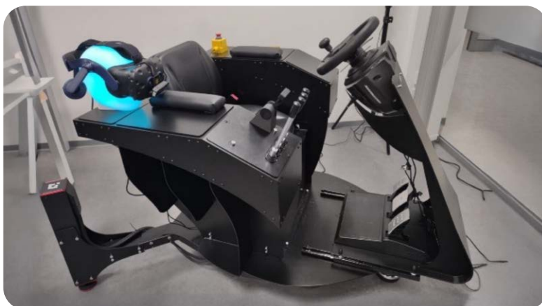
Rys. 12. Symulator VR wózka jezdniowego podnośnikowego czołowego
