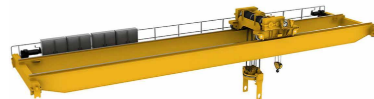
Rys. 6. Przykład suwnicy do przeladunku Fig. 6. Cask handling crane
