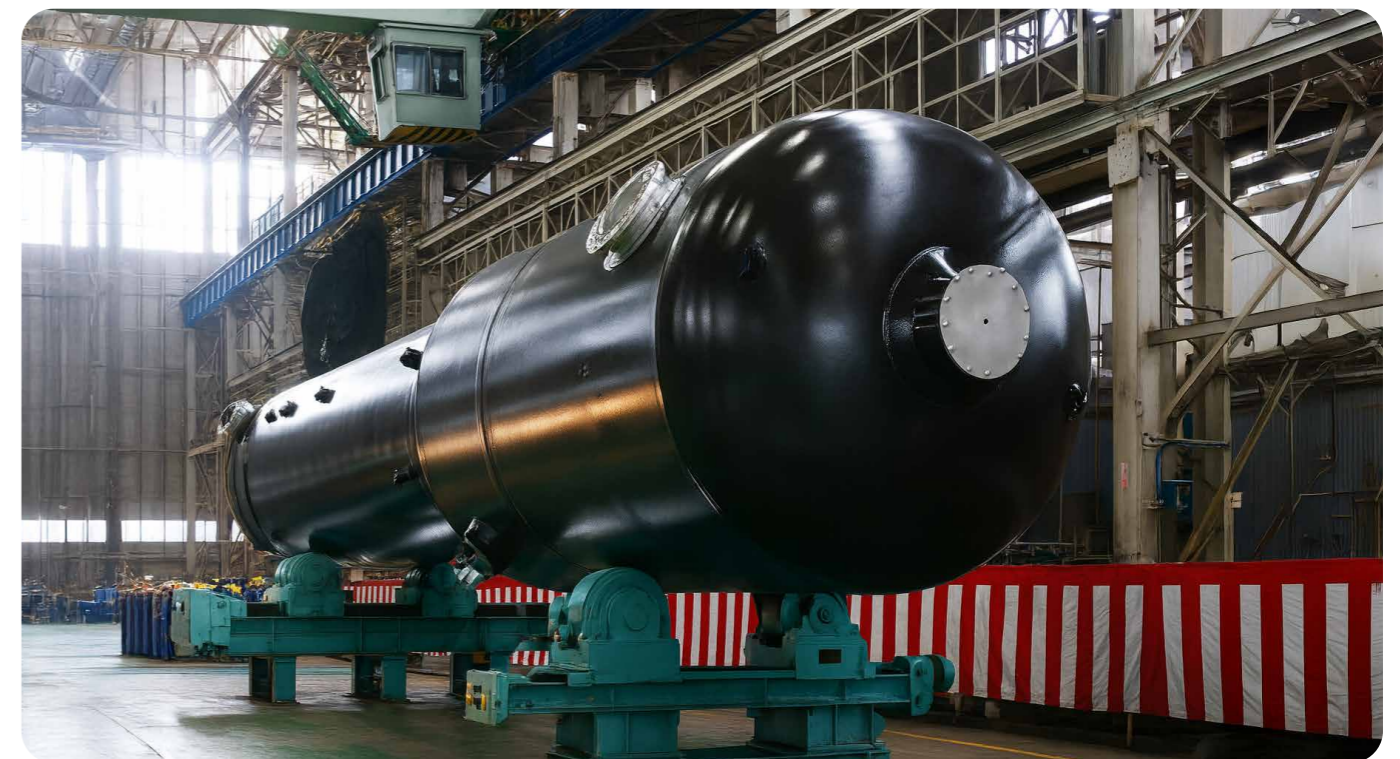
Rys. 3. Wytwornica pary (SG) [6] tj. grupa 2 urządzeń podlegających pod dozór § 2.1 ppkt 2f wg rozporządzenia [3] Fig. 3. Steam generator (SG) [6] – Group 2 equipment subject to inspection under § 2.1(2f) of Regulation [3]
