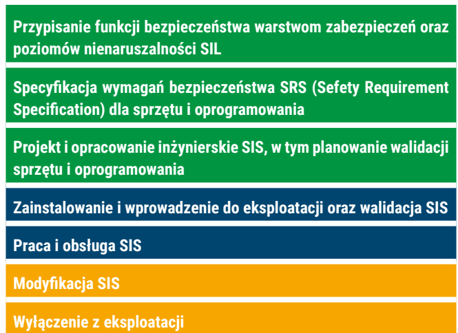
Rys. 1. Cykl życia bezpieczeństwa na podstawie PN-EN61511 i PN-EN50156. Kolorem zielonym oznaczono fazę analityczną, kolorem niebieskim – fazę realizacji, zaś kolorem pomarańczowym – fazę eksploatacji
