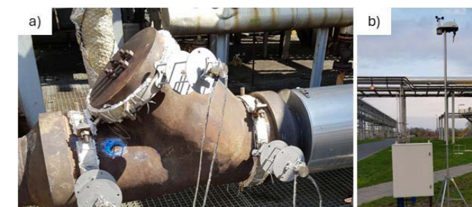
Rys. 4. a) Układ monitorujący z czujnikami emisji akustycznej zamontowanymi na jednym z urządzeń, b) szafa z systemem pomiarowym oraz stacja pogodowa
