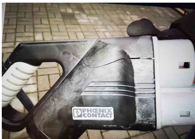
Rys. 1. Pęknięte złącze pojazdowe
