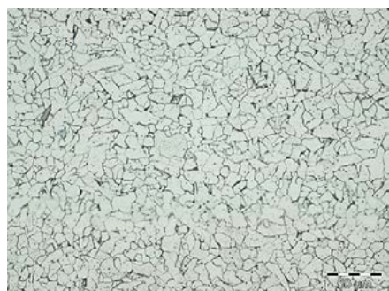
Rys. 9. Widok struktury wycinka rury nr 4 – struktura ferrytyczno-perlityczna z obszarami cementytu III. Powiększenie 500x
