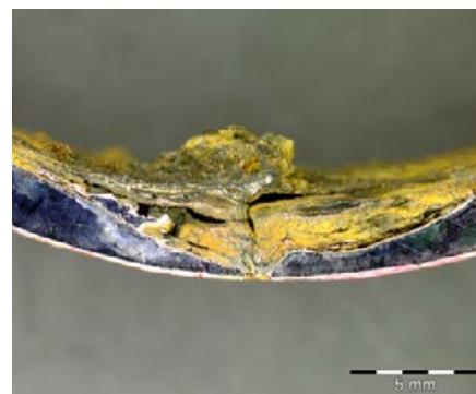
Rys. 15. Wżer korozyjny wzdłuż zgrzewu (rura nr 3). Powiększenie 10x
