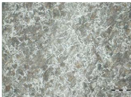
Rys. 10. Struktura ferrytu o wydłużonych ziarnach oraz martenzyt. Liczne ślady budowy widmanstattenowskiej. Powiększenie 500x
