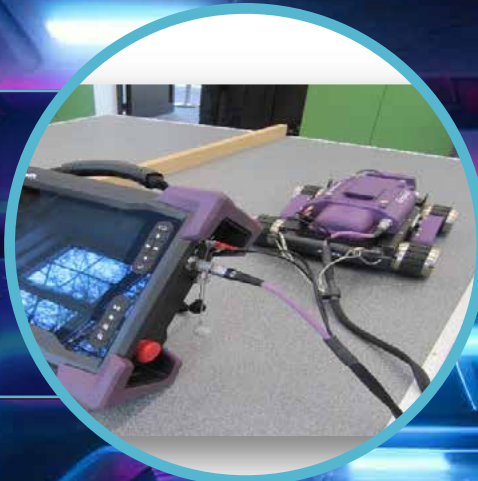
Rys. 8. Robot z napędem magnetycznym Scorpion 2
