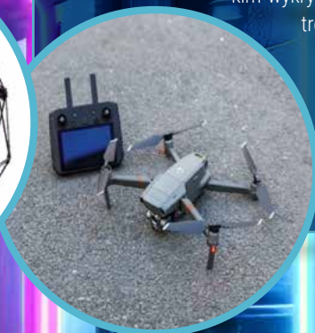
Rys. 4. Dron do przestrzeni otwartych DJI Mavic 2 Enterprise
