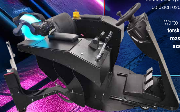
Rys. 11. Symulator pracy wózka jezdniowego podnośnikowego z mechanicznym napędem podnoszenia
