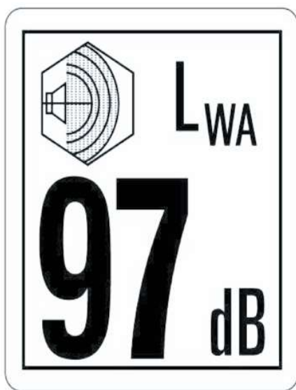
Przykładowe oznaczenie gwarantowanego poziomu mocy akustycznej zgodnie z wymaganiami dyrektywy 2000/14/WE
