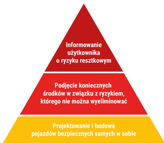
Rys. 8. Triada bezpieczeństwa w odniesieniu do wózków automatycznych
