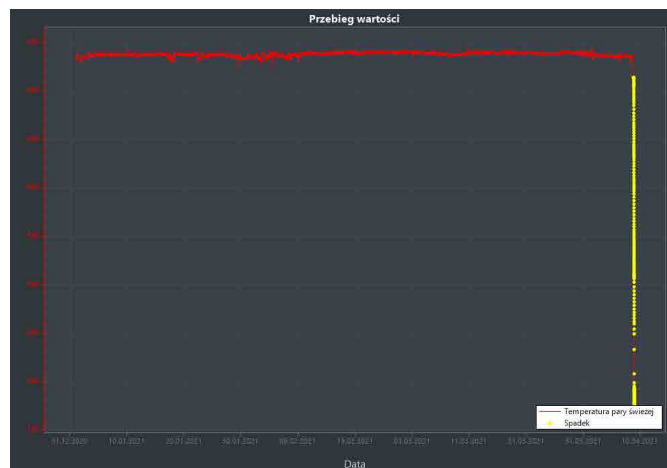
Rys. 8. Przykładowy wykres wykrywania anomalii za pomocą AI z zastosowaniem aplikacji ET Inspektor
