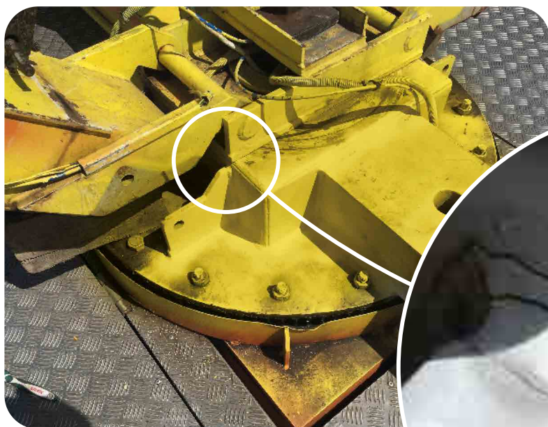
Rys. 6. Przygotowanie do badania MT (zdj. M. Klahs)
