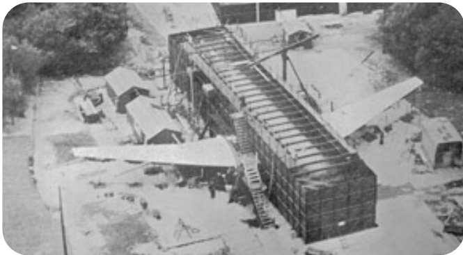
Fot. 3. Widok kadłuba samolotu G-ALYU w zbiorniku w trakcie testów [2]
