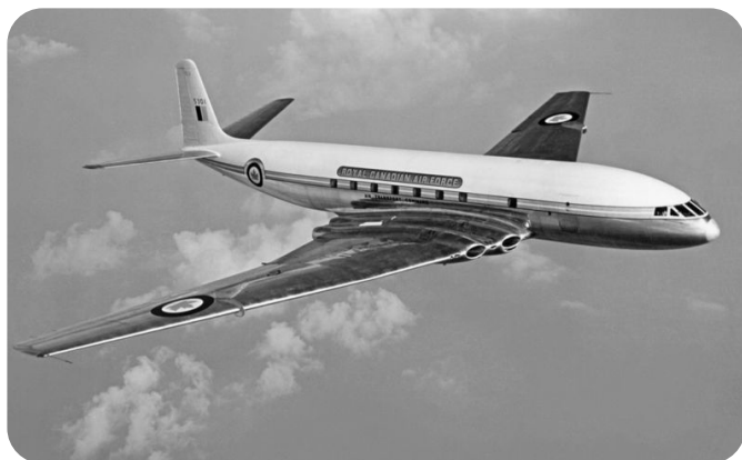
Fot. 1. Samolot de Havilland DH-106 Comet 1 z charakterystycznymi kwadratowymi oknami [12]
