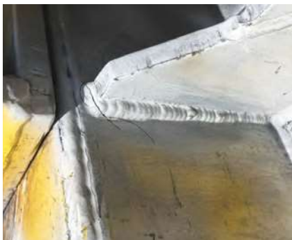
Rysunek 3. Pęknięcie konstrukcji nośnej przenośnika do celów rekreacyjno-rozrywkowych
