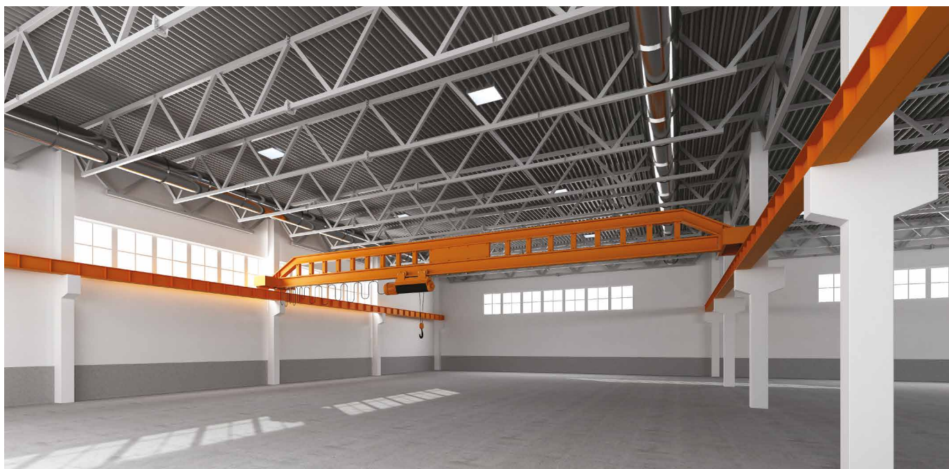
Rys. 1. Suwnica jednodźwigarowa natorowa ogólnego przeznaczenia
