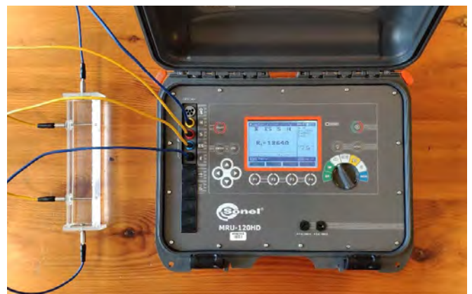
Zdj. 4. Pomiar rezystywności elektrolitu z użyciem naczynia soil-box [4]
