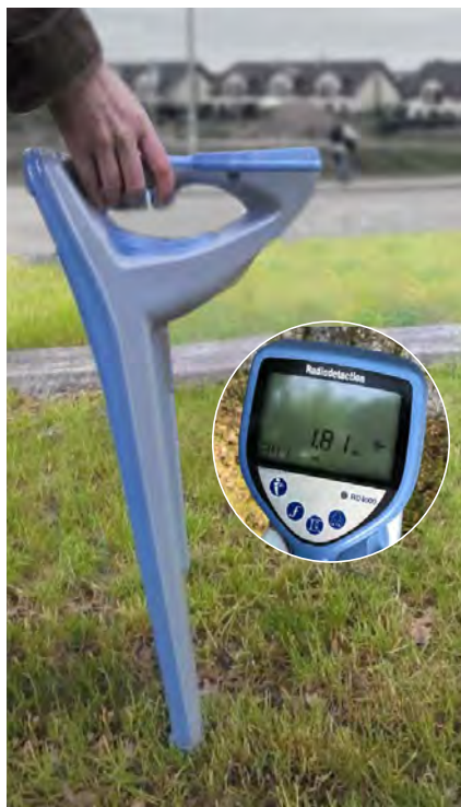
Zdj. 1. Lokalizowanie trasy rurociągu podziemnego wraz z pomiarami głębokości ułożenia oraz tłumienia sygnału prądu przemiennego określonej częstotliwości [4]
