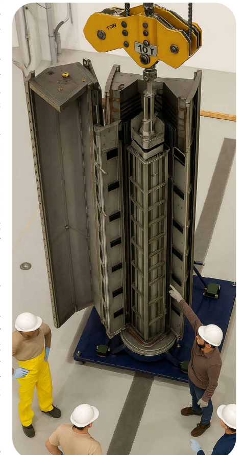
Rys. 2. Załadunek paliwa [6] Fig. 2. Fuel loading operation [6]
