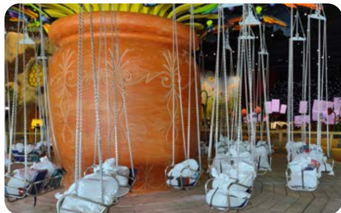
Rys. 4. Przeprowadzanie badania urządzenia z obciążeniem (zdj. M. Klahs)
