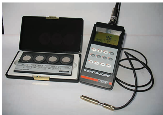
Rys. 6. Przyrząd do badania zawartości ferrytu typ MP30E-S oraz wzorce wtórne %Fe-WRC 1,5/30
