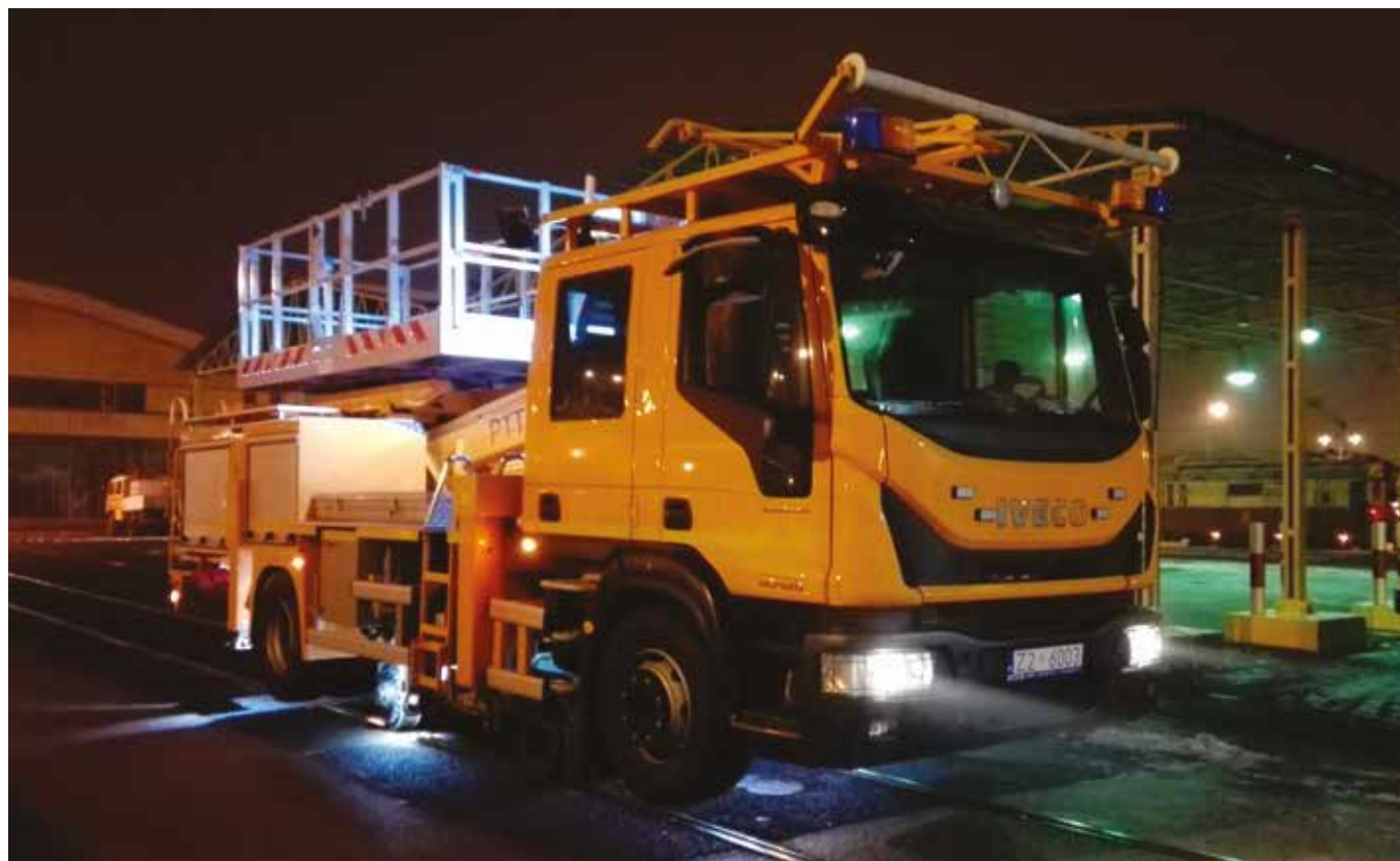
Podnośnik do obsługi trakcji z możliwością jazdy po torach produkcji Bumar-Koszalin (zdj. BUMAR-KOSZALIN S.A.)
