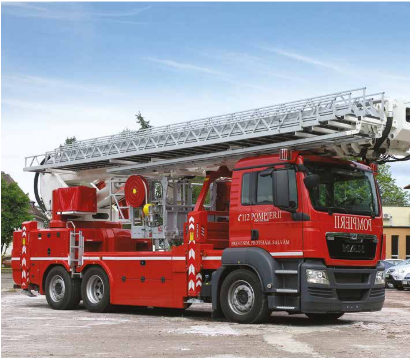
Podnośnik dla straży pożarnej o wysokości podnoszenia 48 m produkcji Bumar-Koszalin (zdj. BUMAR-KOSZALIN SA)
