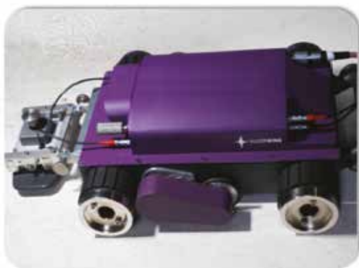
Fot. 3. Robot Scorpion 2 przeznaczony do pomiarów grubości ścianek zbiorników
