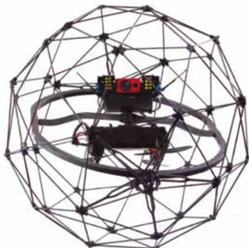
Fot. 1. Dron do rewizji wewnętrznych w zbiornikach
