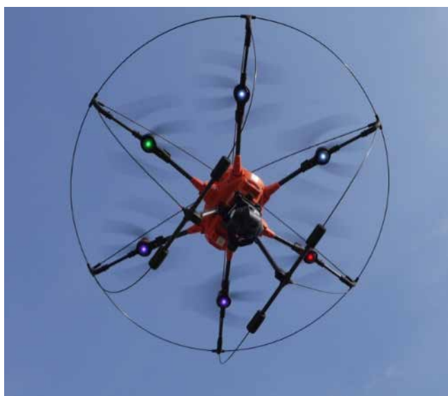
Fot. 5. Wyposażenie drona w klatkę ochronną
