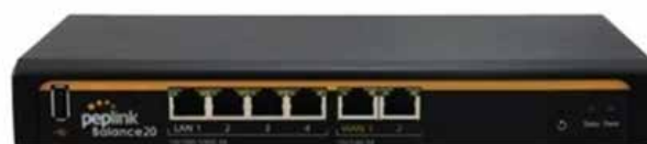
Fot. 4. Routery umożliwiające transmisję z agregacją łączności GSM kilku operatorów
