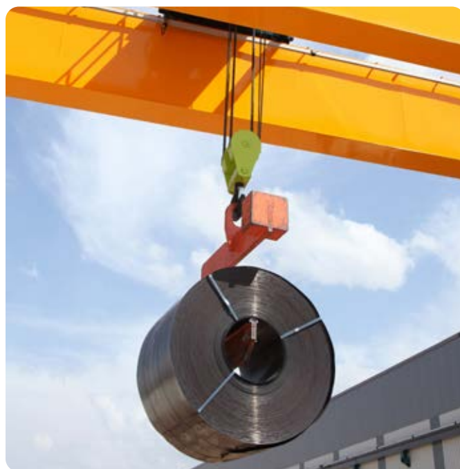
Rys. 2. Badanie okresowe suwnicy – próba obciążeniowa mostu
