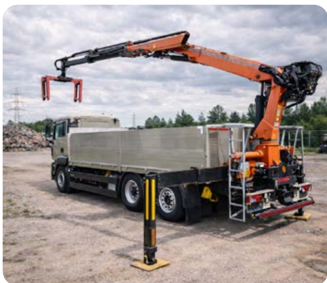
Rys. 8c. Przykład osprzętu dodatkowego montowanego na żurawiu przenośnym przeladunkowym
