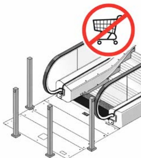
Rys. 4. Bariery uniemożliwiające wjazd wózkiem sklepowym i piktogramy informacyjne
