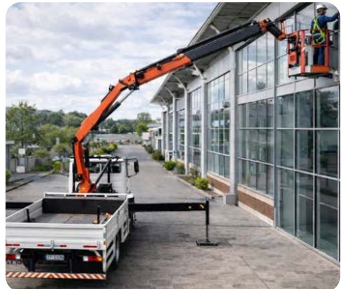
Rys. 8a. Przykład osprzętu dodatkowego montowanego na żurawiu przenośnym przeladunkowym
