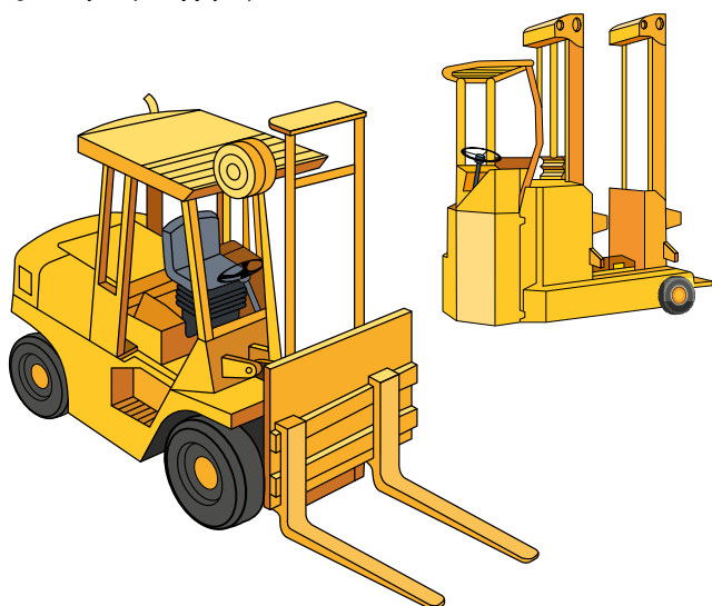
Rys. 4. Wózek jezdniowy podnośnikowy z mechanicznym napędem podnoszenia, w tym wózek wysokiego składowania, tzw. reach truck
