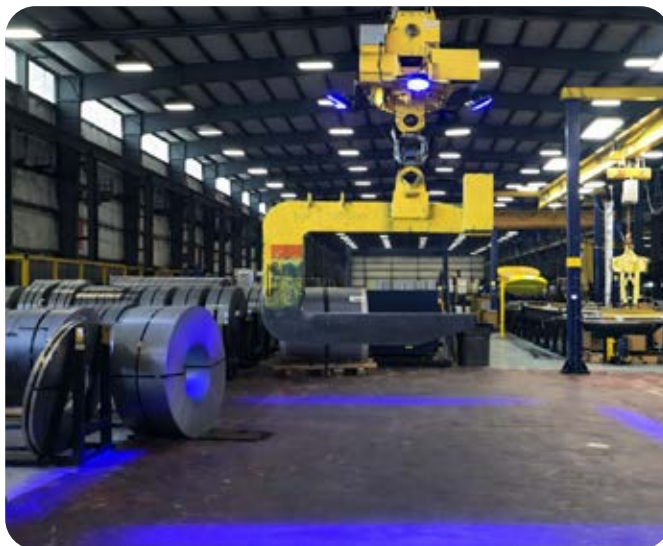
Rys. 6. System wizualnego ostrzegania w strefie niebezpiecznej [www.toptre-safety.com]
