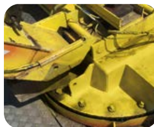
Rys. 6. Przygotowanie do badania MT (zdj. M. Klahs)
