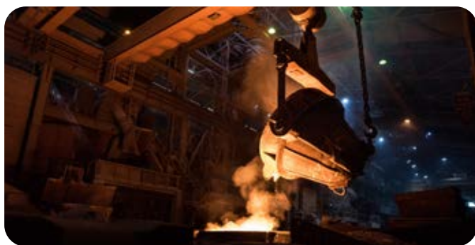
Rys. 1. Opróżnianie kadzi z płynnym metalem przy użyciu suwnicy lejniczej
