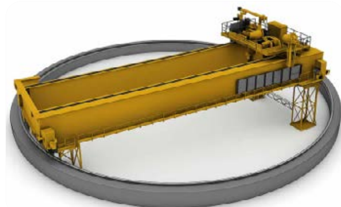
Rys. 4. Przykład suwnicy polarnej
