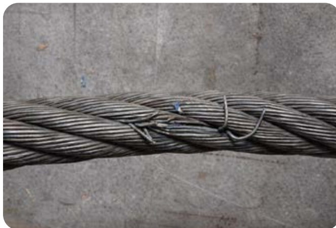
Rys. 4. Przykład zużytego zawiesia linowego
