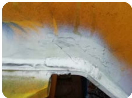
Rys.1. Pęknięcie konstrukcji dźwigara
