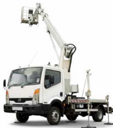
Rys. 1. Podest przejezdny montowany na pojeździe
