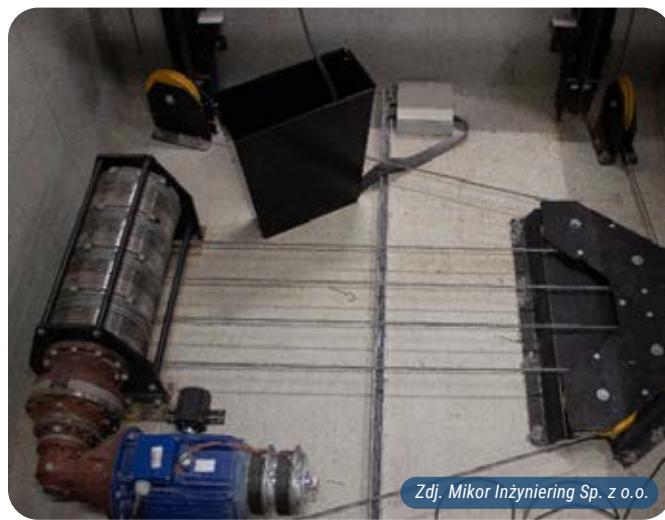
Rys. 12. Zapadnia sceniczna z napędem elektrycznym linowym
