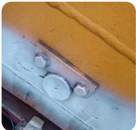
Rys.4. Pęknięcie konstrukcji czołownicy
