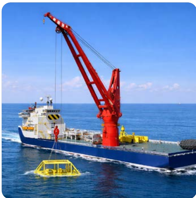
Rys. 9. Żurawie do prac podmorskich
