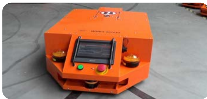
Rys. 1. Wózek z nawigacją z zastosowaniem pętli indukcyjnej [1]
