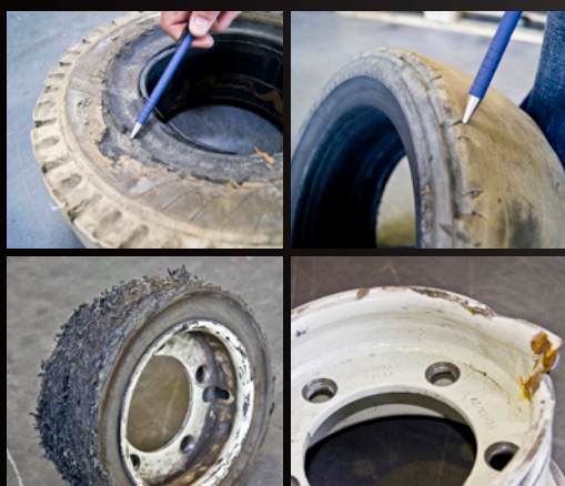
uszkodzenia opon, felg, zużycie bieżnika
