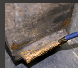
zużyte, urwane zaczepy widel
