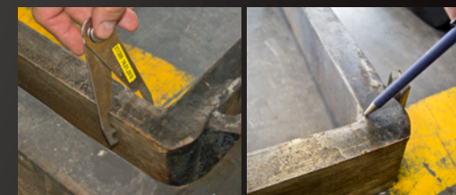
zużycie widel, zmniejszenie grubości o ponad 10 proc. wartości nominalnej
