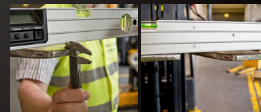
nadmierne rozgięcie widel, tzn. różnica wysokości końców widel przekracza wartość 3 proc. ich długości
