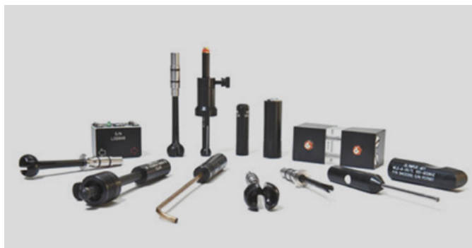
Rysunek 14. Przykłady przetworników wiropądowych
