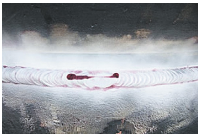
Rysunek 8. Przykład nieciągłości stwierdzonej metodą penetracyjną
