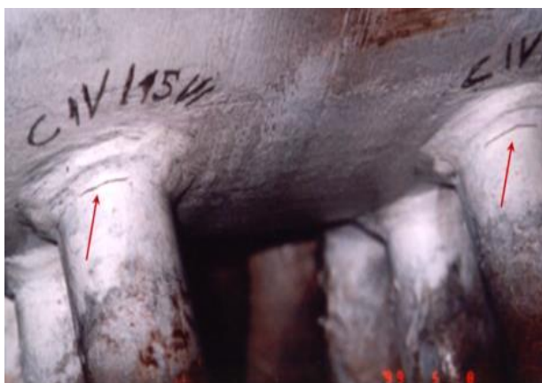
Rys. 17. Przykłady pęknięć obwodowych złączy kątowych na powierzchni zewnętrznej króćców komór przegrzewacza pary ujawnione metodą magnetyczno-proszkową.
