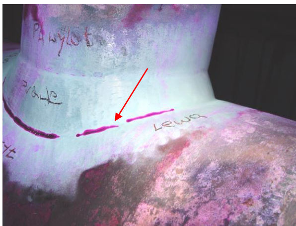
Rys. 16. Pęknięcie w obwodowym złączu kątowym zawieszenia komór wylotowych przegrzewacza pary ujawnione za pomocą badań penetracyjnych.
