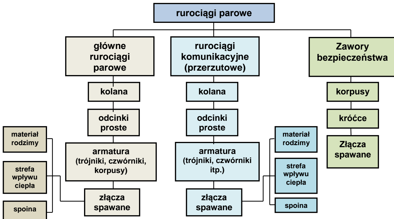
Rys. 6. Rurociągi parowe i miejsca w których poddawane są badaniom diagnostycznym.
