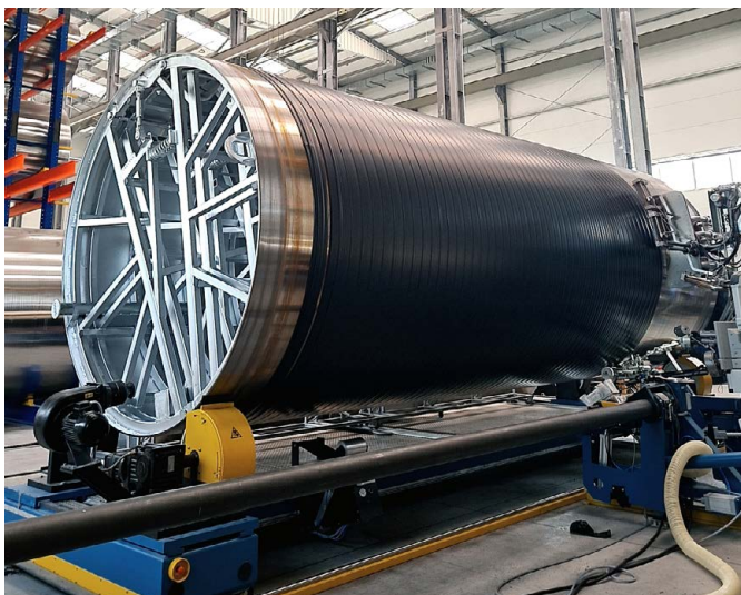
Rys. 3. Linia produkcyjna do wytwarzania cylindrów zbiorników i rur technologią ekstruzji uplastycznionej wstęgi tworzywa i nawijania (technologia AmargTank SafeSeamLess®, MultiLayer® oraz MultiLayer DoubleWall®) (zdj. AMARGO®)
