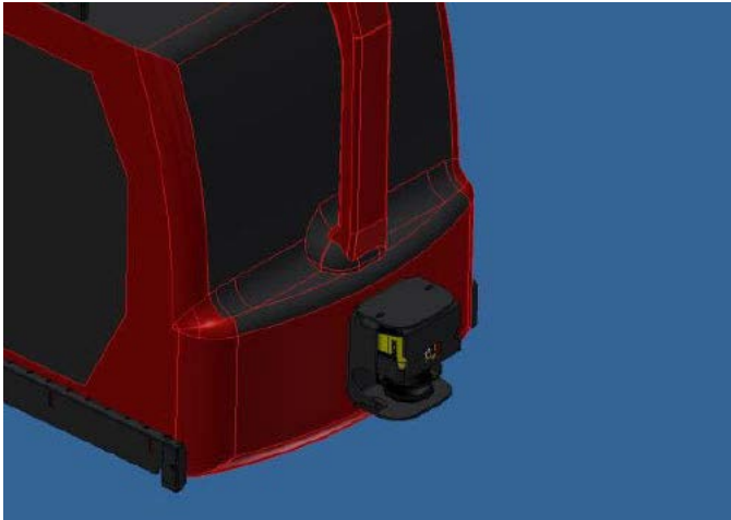
Rys. 19. Usytuowanie skanera strefy bezpieczeństwa na wózku [2]
