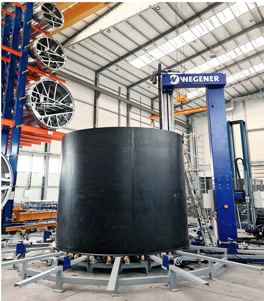
Rys. 2. Produkcja zbiornika technologią tradycyjną, czyli AmargTank ClassicWeld® polegającą na wykorzystaniu półproduktów – arkuszy tworzywa sztucznego (na zdjęciu – proces cylinder zbiornika) (zdj. AMARGO®)
