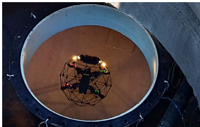
Rys. 3 . Zdjęcia z przebiegu badań zbiornika paliwa z poziomu otoczenia – stacja Shell (zdj. ZBM S.A.)
