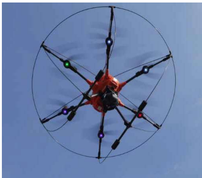
Fot. 5. Wyposażenie drona w klatkę ochronną
