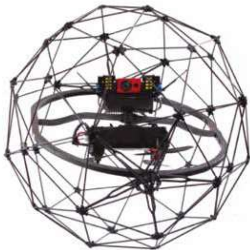
Fot. 1. Dron do rewizji wewnętrznych w zbiornikach
