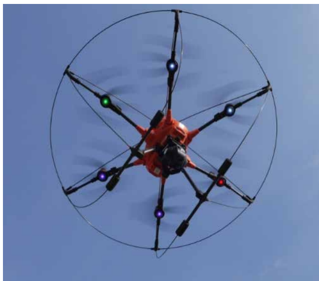
Fot. 5. Wyposażenie drona w klatkę ochronną
