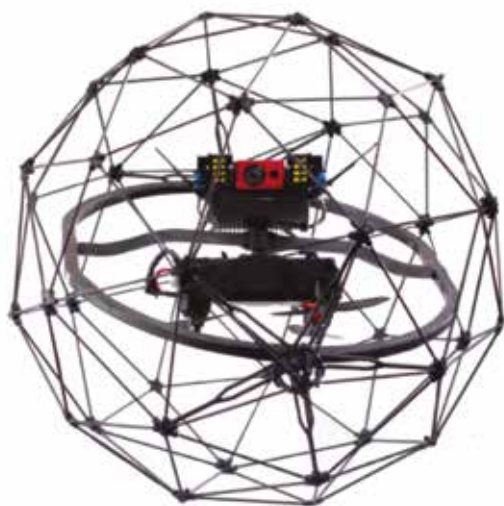
Fot. 1. Dron do rewizji wewnętrznych w zbiornikach
