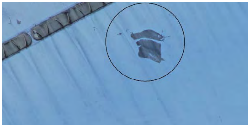
Rys. 1. Ubytki powłoki lakierniczej na powierzchni łopaty
