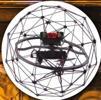
Zdj. 1. Dron klatkowy ELIOS 1 (Flyability)
