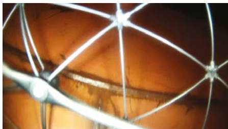
Zdj. 3. Obrazy z kamery z badania zbiornika w atmosferze azotowej dronem Elios 1
