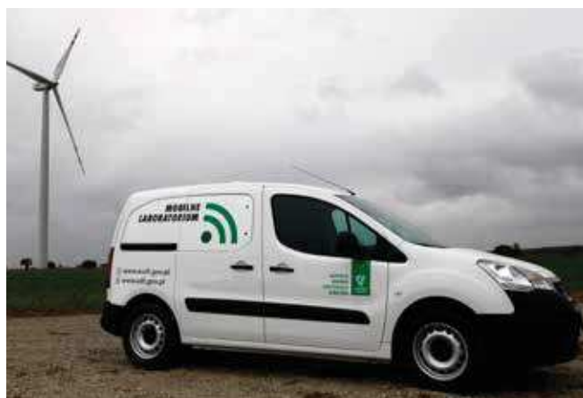
Zdj. 3 W odróżnieniu od prezentowanych we wcześniejszych numerach Inspektora, „dużych” laboratoriów mobilnych ze stanowiskiem pomiarowym, tutaj do badań wykorzystuje się mniejsze samochody do przewozu kompletnego zestawu badawczego - następnie transportowanego do roboczego stanowiska w gondoli
