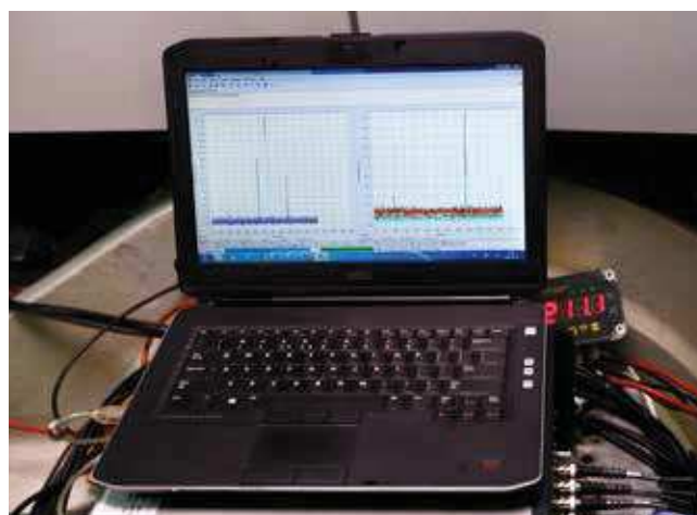
Zdj. 1 Robocze stanowisko pomiarowe zlokalizowane w gondoli – widoczny system pomiarowy wraz z komputerem przenośnym oraz wyświetlacz połączony z przetwornikiem ciśnienia przedstawiający aktualne ciśnienie w układzie hydraulicznym
