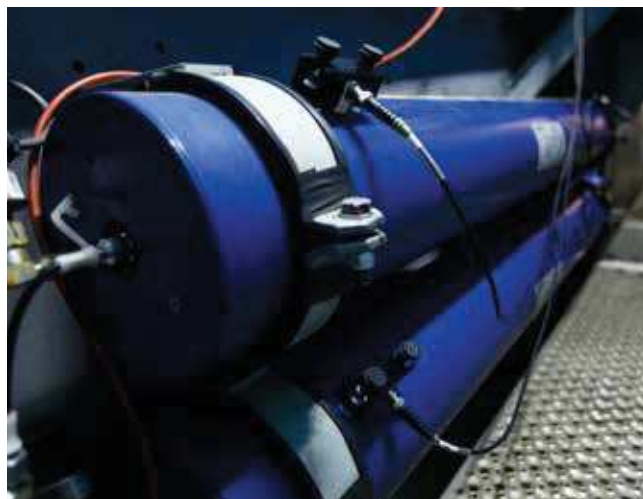
Zdj. 2 Czujniki wraz z uchwytami magnetycznymi zamontowane na badanych hydroakumulatorach tłokowych
