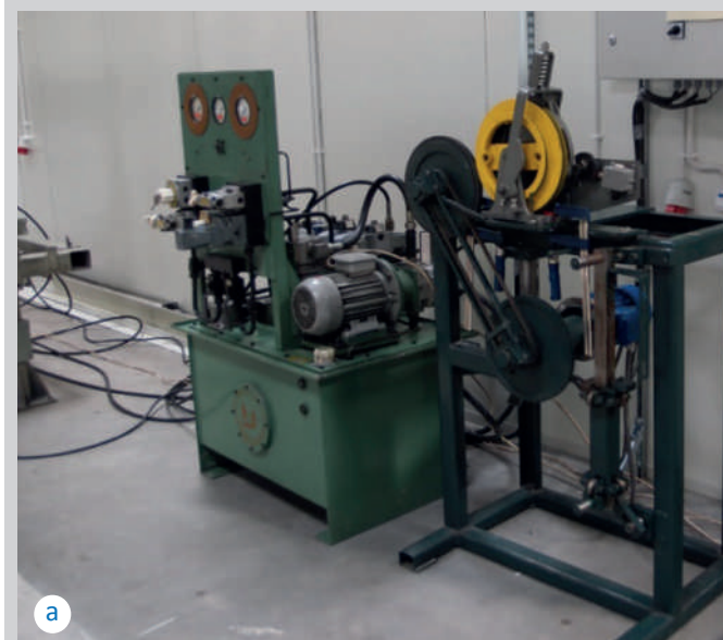
|| Laboratorium badawcze UDT CLDT w Poznaniu, a) stanowisko do pomiarów prędkości wyzwalania dźwigowych ograniczników prędkości, b) stanowisko do badań trwałościowych układów ryglowania dźwigowych drzwi przystankowych
