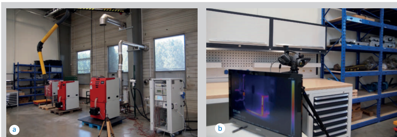
|| Laboratorium badawcze UDT CLDT w Poznaniu, a) stanowisko do badań urządzeń grzewczych na paliwo stałe, b) stanowisko do badań termowizyjnych
