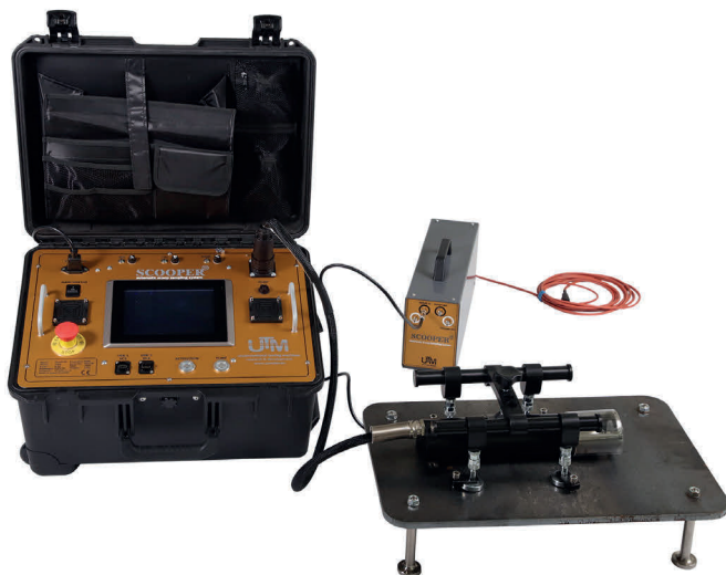
SCOOPER 50 – urządzenie do pobierania wycinków materiałów do badań
