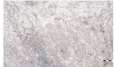
Rys. 11. LM. Spoina w środku grubości. Strefa oddziaływania cykli ciepłych pochodzących od układania kolejnych ściegów. Utrata pierwotnego charakteru struktury
