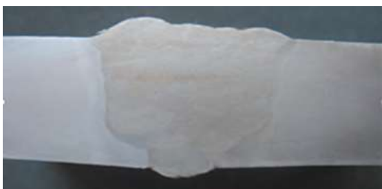
Rys. 4. Widok zglądu makro złącza spawanego stali X10CrMoVNb9-1 + 14MoV6-3
