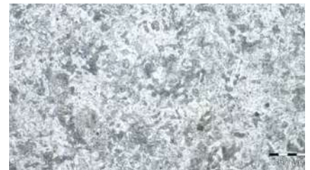
Rys. 12. LM. Spoina w obszarze grani. Strefa oddziaływania cykli ciepłych pochodzących od układania kolejnych ściegów. Zrekrytalizowana struktura drobnoziarnista, ferryt-bainit + węgliki
