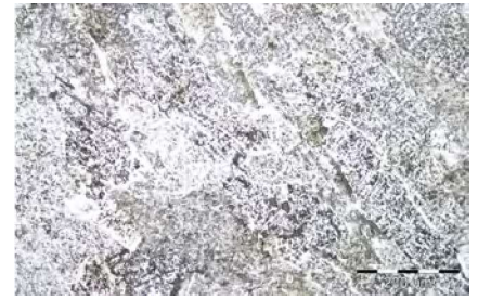
Rys. 10. LM. Spoina od strony licy. Struktura dendrytyczna. Widoczne wyraźne kryształy kolumnowe
