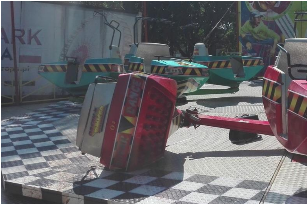
Zdjęcie 34. Wypadek i niebezpieczne uszkodzenie spowodowane pęknięciem w jednym z węzłów konstrukcyjnych.
