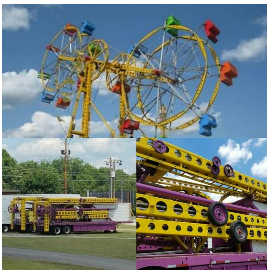
Zdjęcie 17. Przykłady konstrukcji wież, wysięgników i podpór kratownicowych stosowanych w karuzelach mobilnych.
