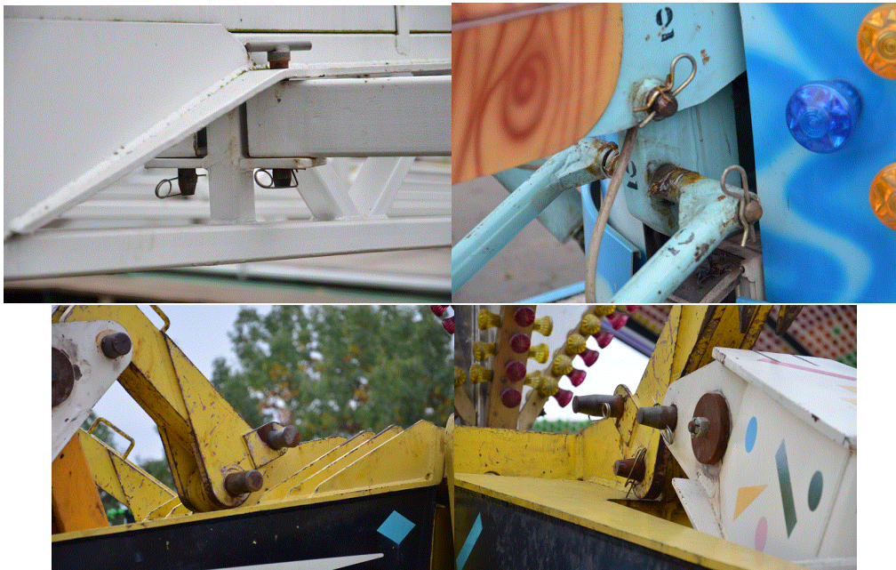
Zdjęcie 27. Przykłady połączeń sworzniowych karuzel.
