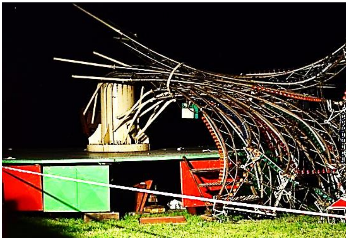
Zdjęcie 37. Wypadek karuzeli spowodowany niedopuszczalnym zwiększeniem obrotów.
