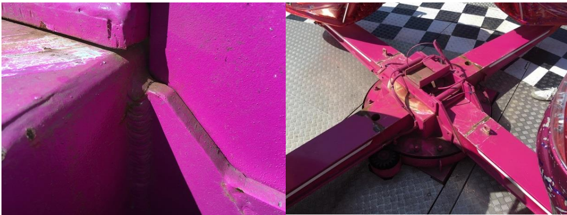
Zdjęcie 28. Pęknięcia konstrukcji nośnej w okolicy wieńca obrotowego gondoli.
