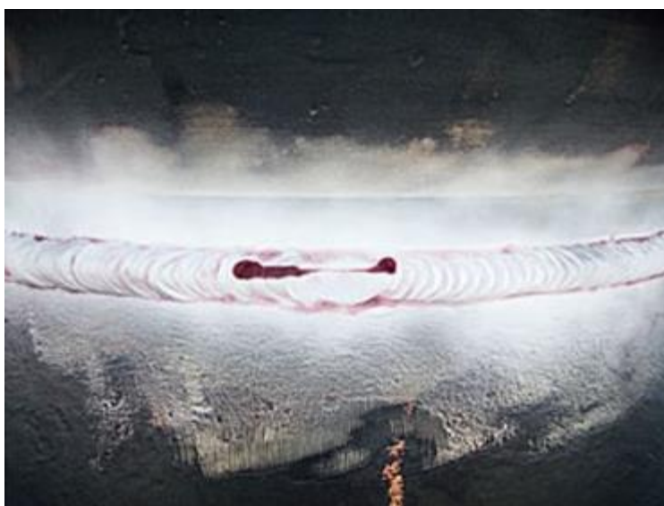
Rysunek 30. Przykład nieciągłości stwierdzonej metodą penetracyjną.
