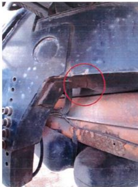
Rysunek 49. Uszkodzenia konstrukcji nośnej ramy podestu montowanego na pojeździe w miejscu mocowania podpór.
