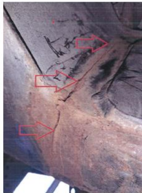
Rysunek 49. Uszkodzenia konstrukcji nośnej ramy podestu montowanego na pojeździe w miejscu mocowania podpór.
