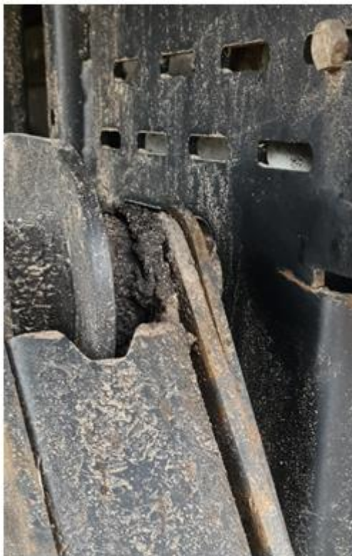
Rysunek 48. Rozwarstwienie blachy konstrukcji nośnej podestu załadownego.
