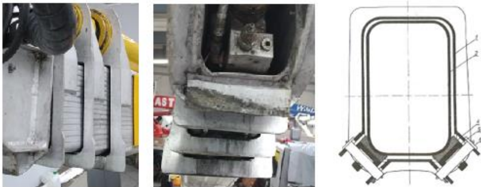
Rysunek 27. Przykład aluminiowego wysięgnika o przekroju czworobocznym
