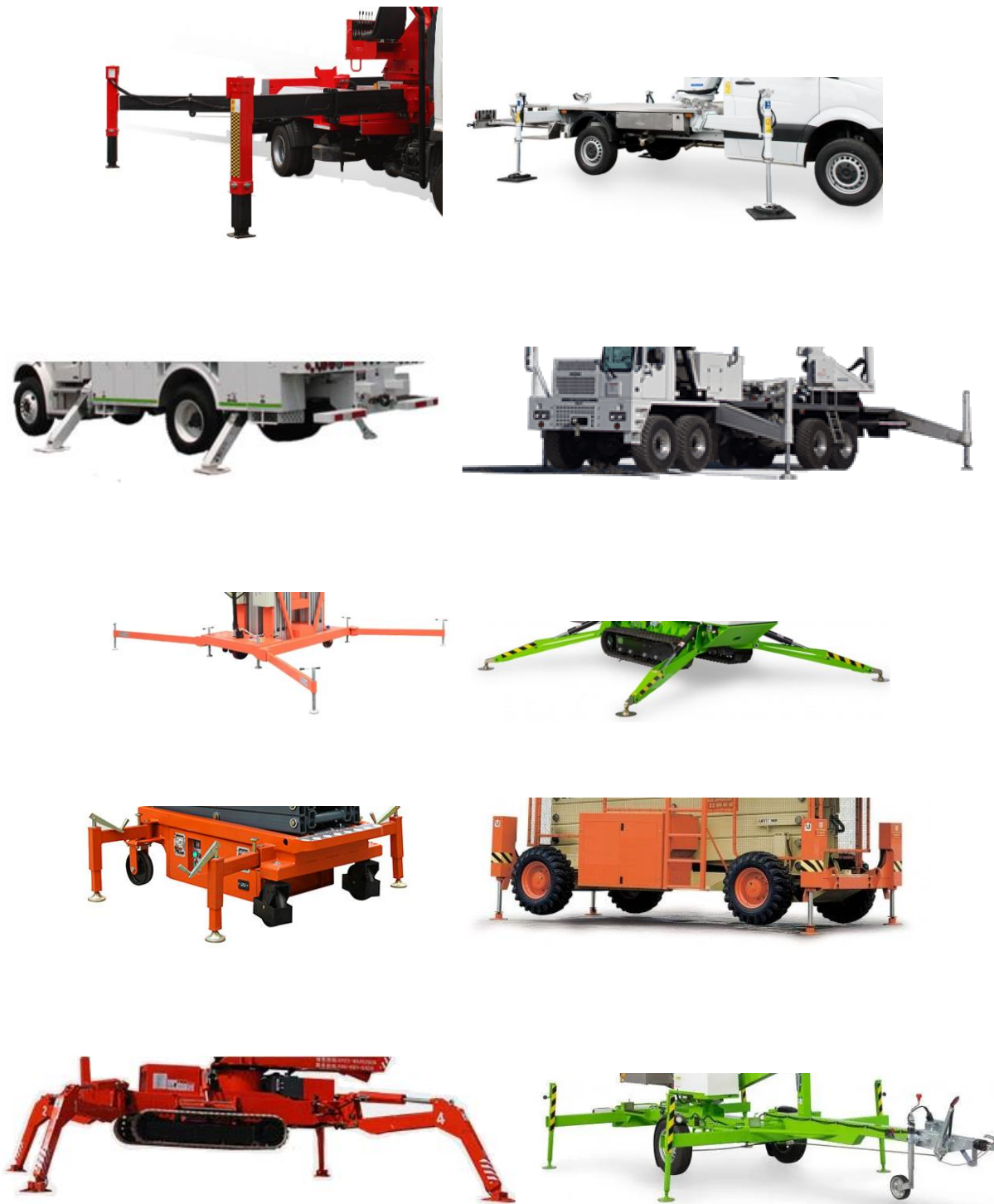
Rysunek 36. Przykłady podpór podestów ruchomych przejezdnych.
