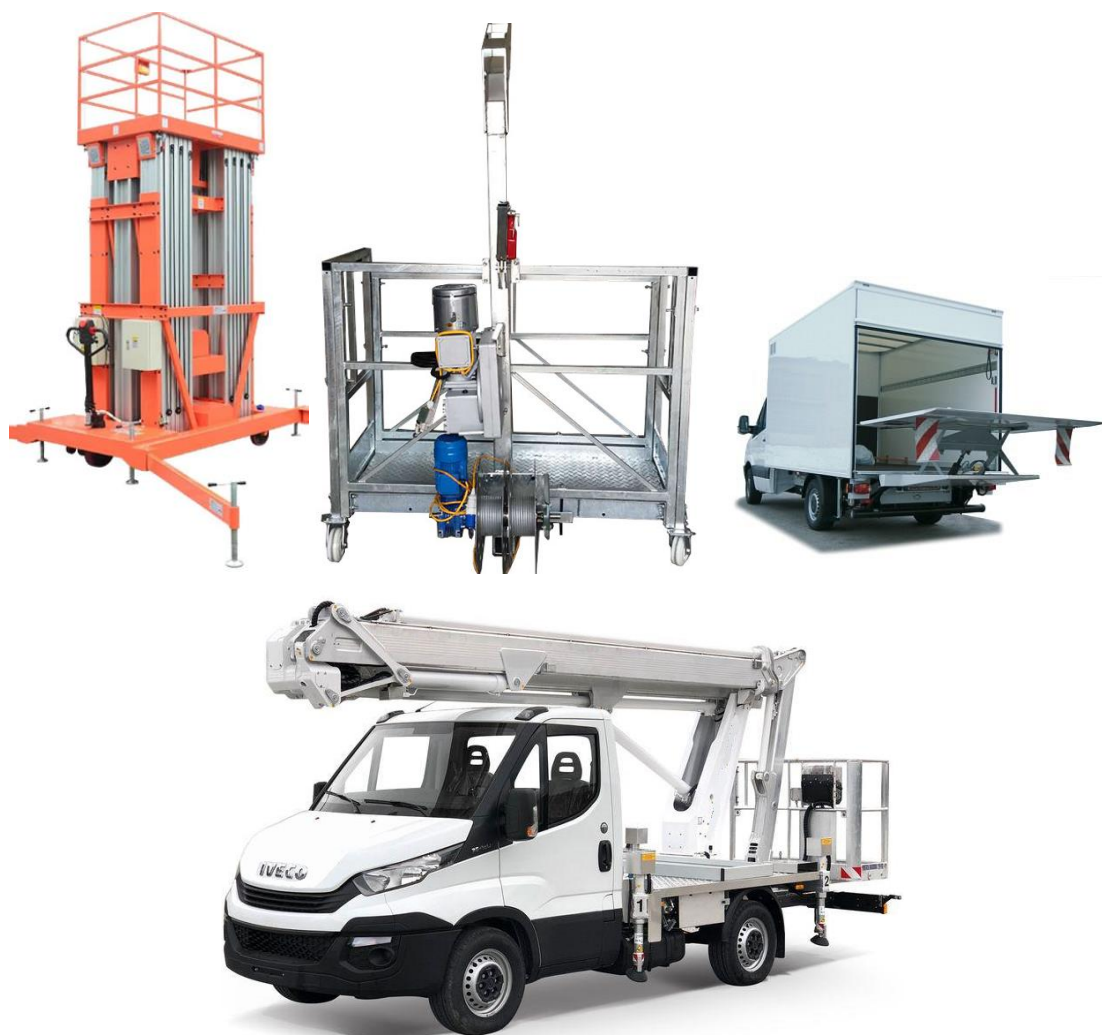
Rysunek 40. Podesty ruchome w którym wykorzystano aluminium na konstrukcje nośne.
