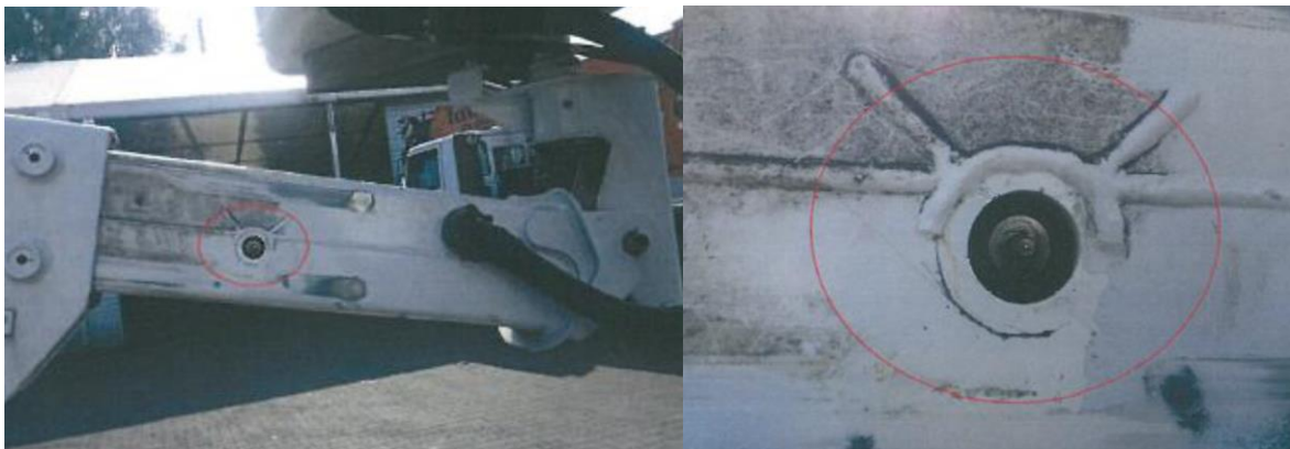
Rysunek 55. Pęknięcie wysięgnika w miejscu mocowania siłownika teleskopowania.
