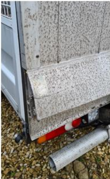
Rysunek 47. Pęknięcia konstrukcji platformy podestu załadownego.
