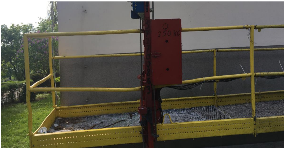
Rysunek 44. Deformacja elementów platformy podestu wiszącego.
