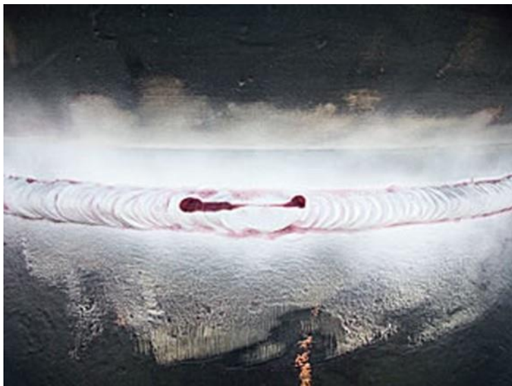
Rysunek 41. Przykład nieciągłości stwierdzonej metodą penetracyjną.
