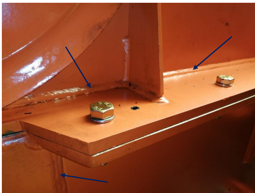
Rysunek 34. Przykładowe spoiny górnego zespołu prowadzącego układnicy podlegające badaniom.
