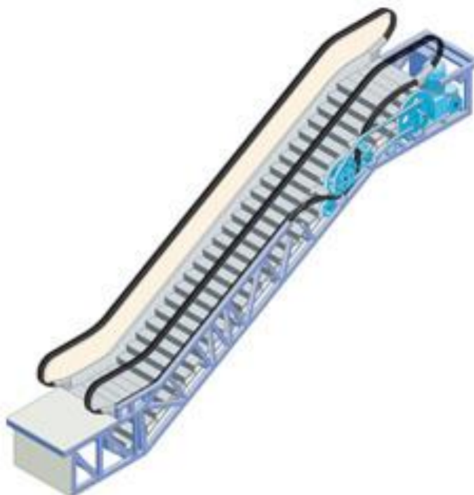
Rysunek 21. Konstrukcja nośna schodów ruchomych
