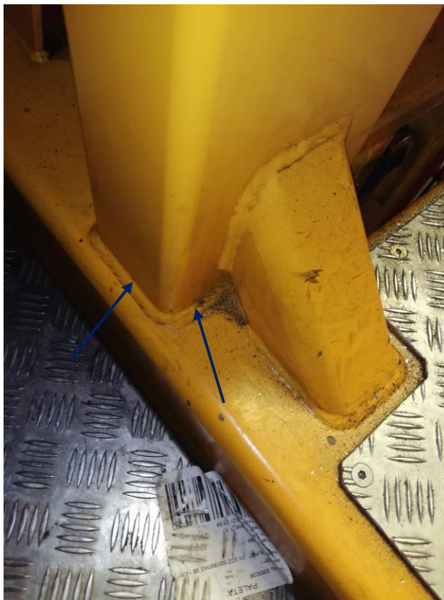
Rysunek 33. Przykładowe spoiny podstawy ładunkowej układnicy podlegające badaniom.
