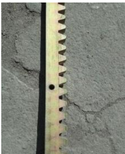
Zdjęcie 5. Listwy zębate z napędu dźwigów budowlanych.
