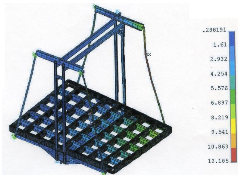
Rysunek 36. Przemieszczenia podłogi [mm], belki podporowej oraz cięgna wspornikowego ramy kabinowej.
