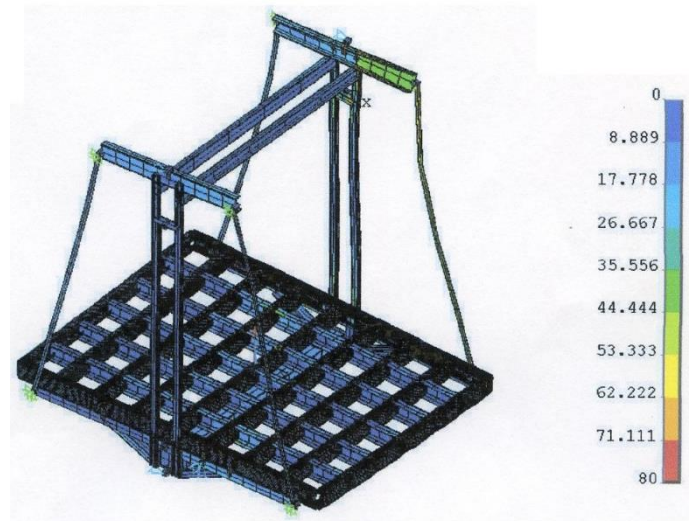
Rysunek 37. Widok ogólny ramy kabinowej ze wskazanym rozkładem naprężeń [MPa].
