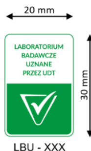
Rys. 1 Podstawowe wymiary znaku
